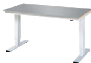
Edelstahlblech-Platte Oberfläche mit 1,5 mm starkem Edelstahlbelag (NIROSTA®). Edelstahl nach X5CrNi18-10, Werkstoffnummer 1.4301 gem. DIN EN 17441/10088-2. Stärke 25 mm, Umbug vorne in L-Form.
