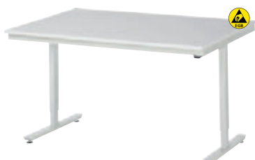
EGB-Melamin-Platte Ober- und Unterseite mit einer leitfähigen, lichtgrauen Melaminharz direktbeschichtung (nach DIN 68765). Volumenleitfähige Mittel-lage. Normaler Abriebwiderstand, bedingte Kratz- und Stoßfestigkeit. Stärke 28 mm
